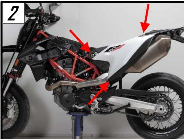
Lösen Sie die Halterschraube und die Schelle des Serienschalldämpfers und nehmen diesen ab (Abb. 3 / 4). Loosen the bracket screw and the clamp of the serial muffler and remove it (pic.3 / 4).
